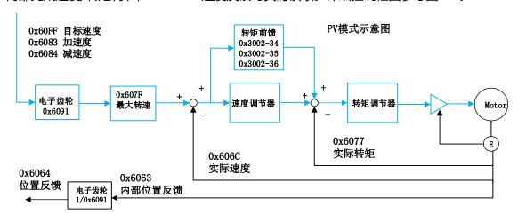
图 4.5 PV 控制框图
