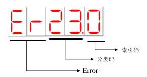
图 9.1 伺服数码管故障状态显示
