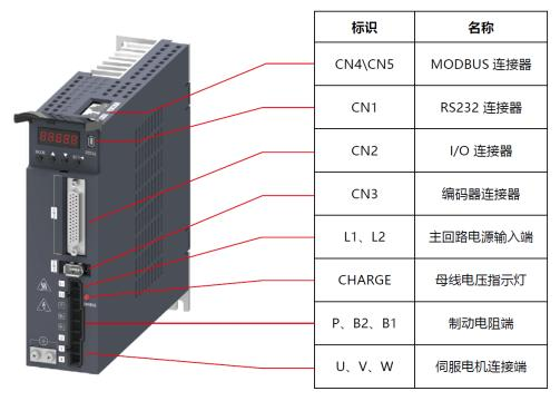
图 2.1 RS2C 伺服驱动器接口示意图
