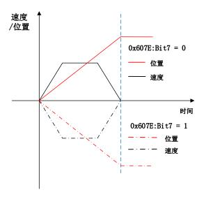
图 3.4 0x607E 指令极性设置与电机运转关系
