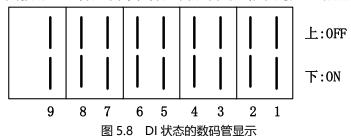
数码管上段亮灯,输入信号 OFF, (内部关断,高电平状态);
