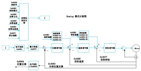
图 4.9 回原点模式控制框图
