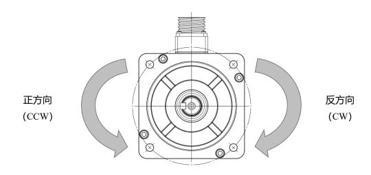
图 5.1 电机旋转方向的设置
