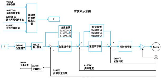
图 4.7 IP 控制框图
